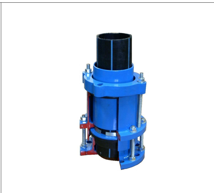
Relining spojnica za spajanje sa armaturom ili nastavljjanje cevi prilikom provlačenja novih PE cevi kroz postojeće stare cevovode, "restraint" sistem povezivanja
